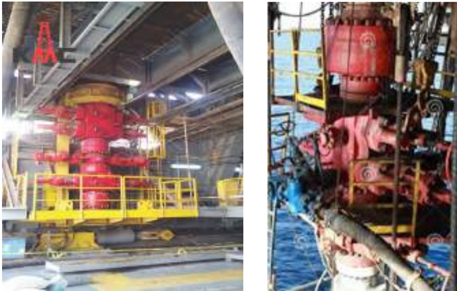
Slika 1.23 Preventerski sklop – BOP (izvor: http://www.drilltech.cn )
