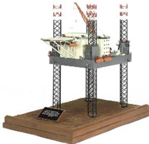
Slika 6. Shema samopodižuće bušaće platforme (Jack-up drilling rig)
