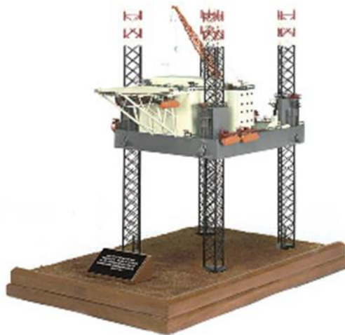
Slika 6. Shema samopodižuće bušaće platforme (Jack-up drilling rig)
